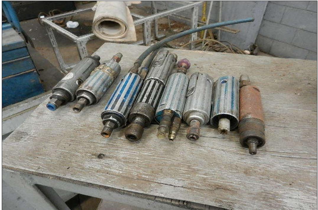
1.006 – VISTA DAS ESMERILHADEIRAS PNEUMÁTICAS
