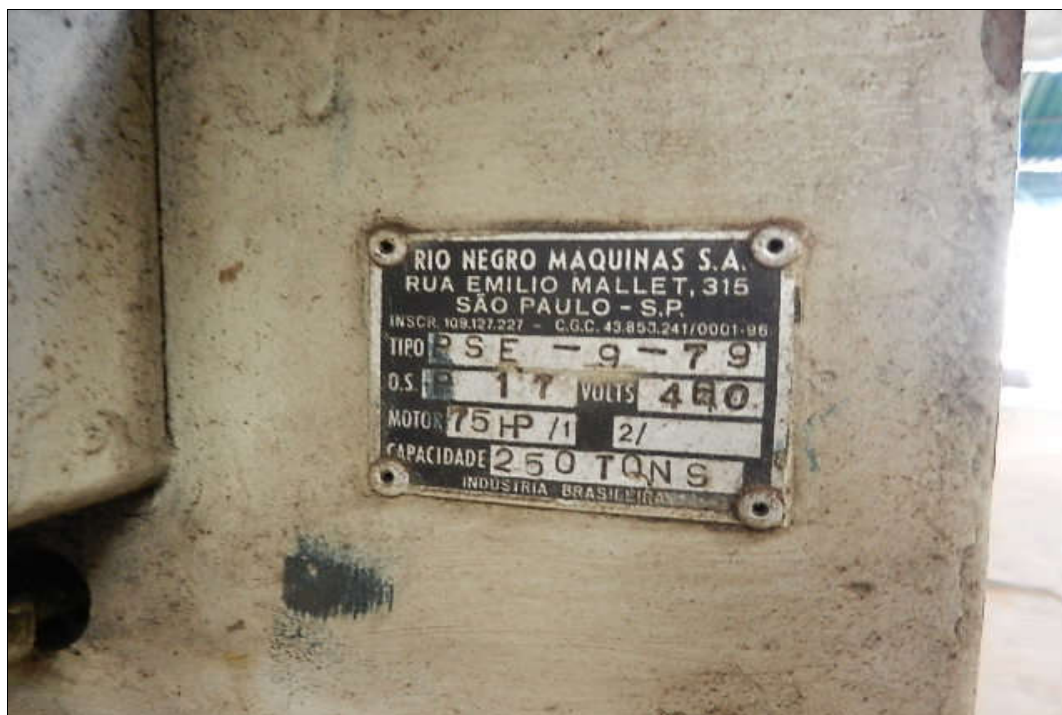
1,003 – VISTA DA PRENSA HIDRAULICA 4 COLUNAS MARCA: RIO NEGRO CAP: 250 TON DIMENSÃO DA MESA: 2.450 X 3.000 MM
