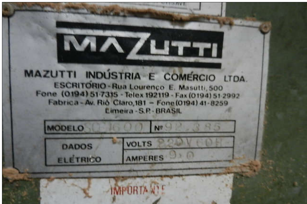
2,001 – VISTA DA PLACA DE IDENTIFICAÇÃO DA SERRA CIRCULAR MARCA: MAZUTTI MODELO: SCE-1600 Nº: 92.385
