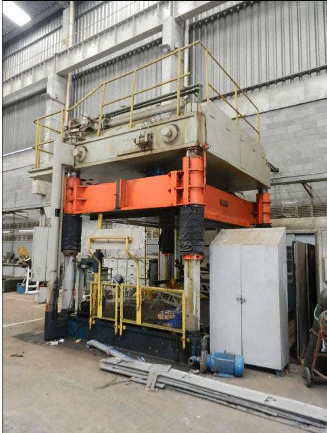
1,003 – VISTA DA PRENSA HIDRAULICA 4 COLUNAS MARCA: RIO NEGRO CAP: 250 TON DIMENSÃO DA MESA: 2.450 X 3.000 MM
