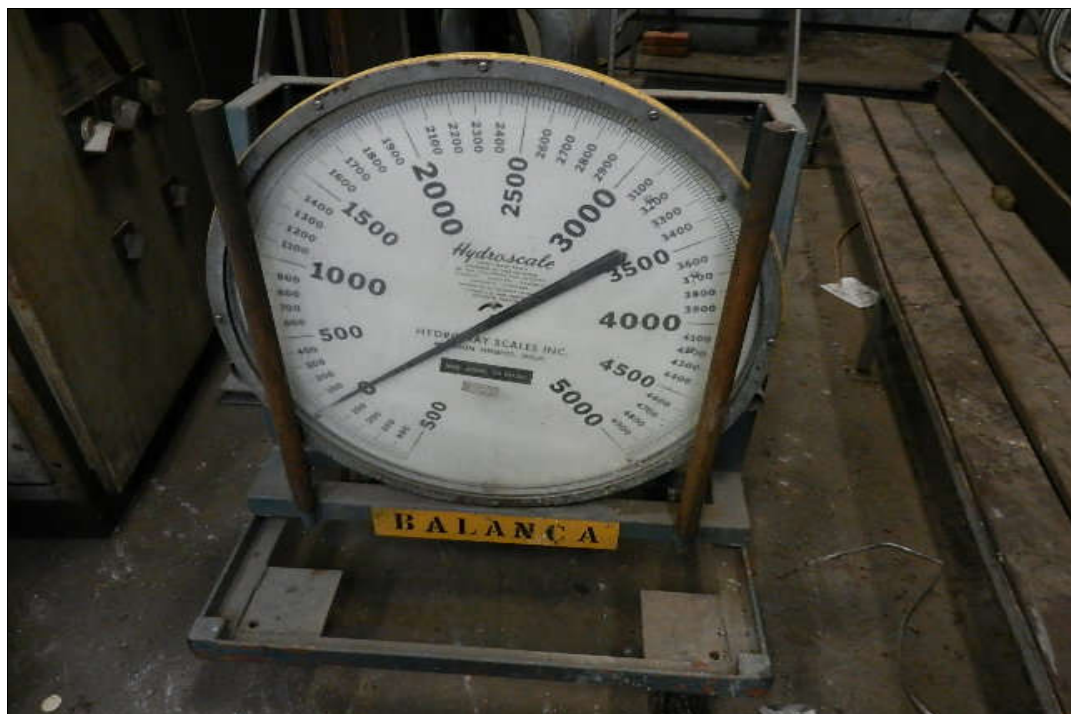
2,003 – VISTA DA BALANCA PARA PONTE ROLANTE MARCA: HYDROSCALE CAP: 5.000 KG
