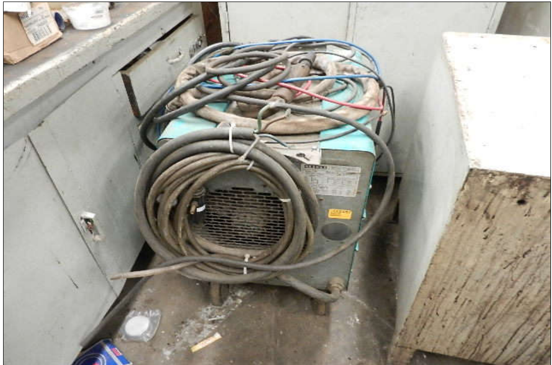
1.008 – VISTA DA MAQUINA DE CORTE A PLASMA MARCA: MERKLE MODELO: CUT-800
