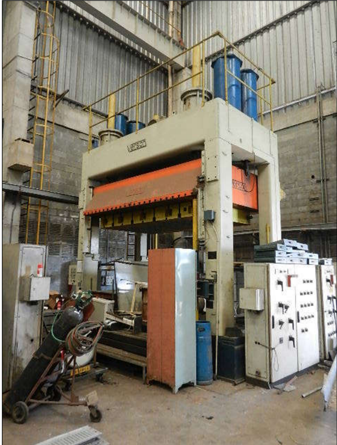
1,001 – VISTA DA PRENSA HIDRAULICA DE 4 COLUNAS MARCA: VERSON CAP: 90 TON DIM: MESA: 2.540 X 3.500 MM
