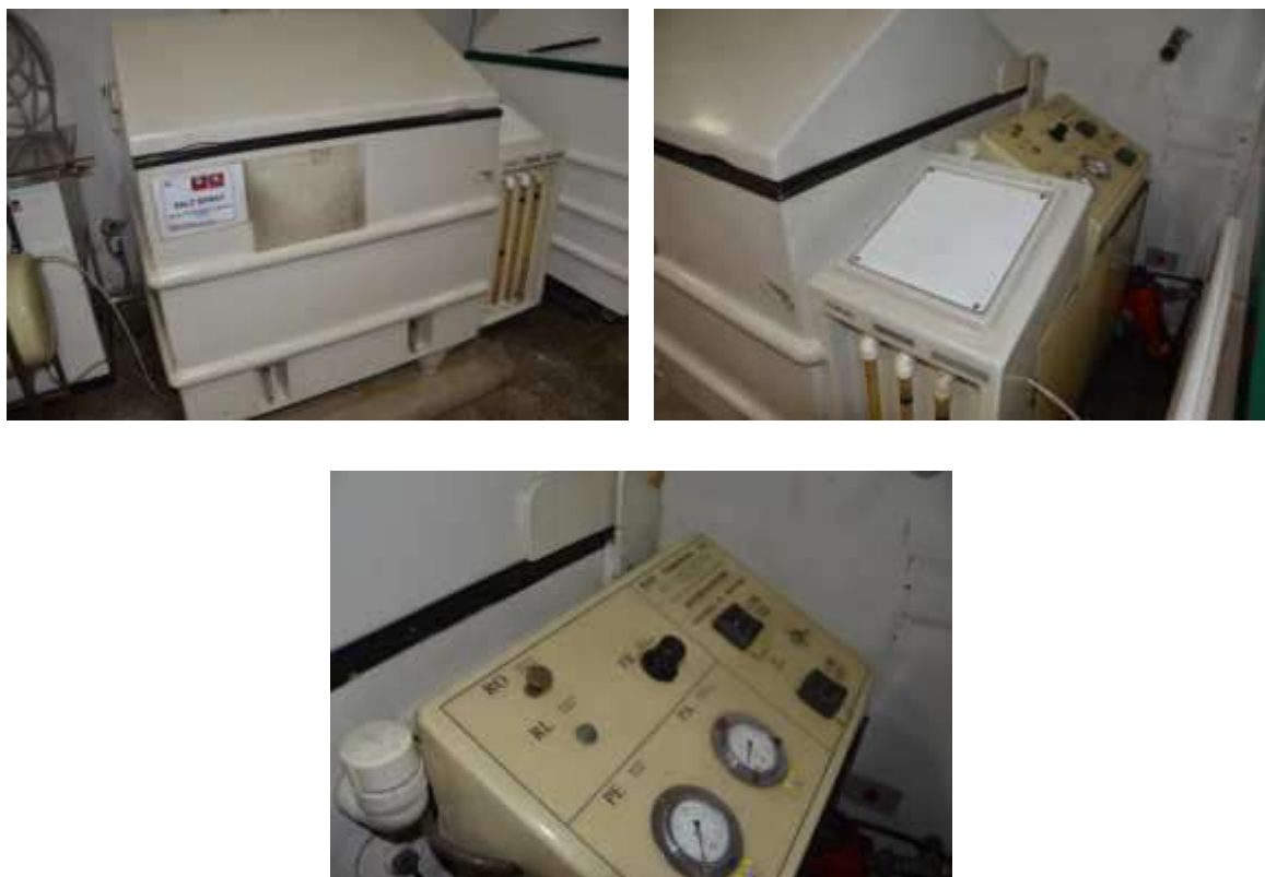
FIGURA 2 - SALT SPRAY (ENSAIO DE RESISTÊNCIA A CORROSÃO SALINA) - MODELO SSC 500E
