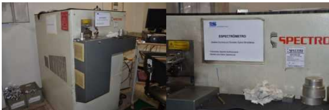
FIGURA 4 - ESPECTRÔMETRO (ANÁLISE QUÍMICA POR EMISSÃO ÓPTICA SIMULTÂNEA)
