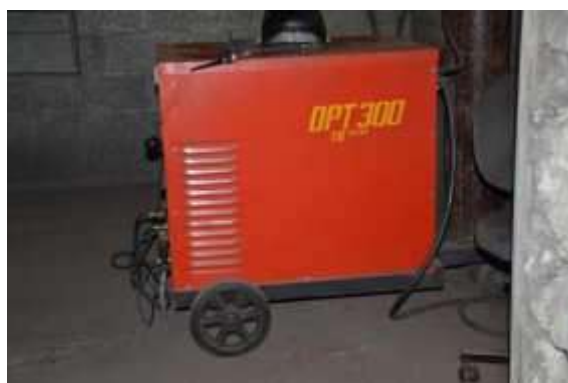
FIGURA 29 - MAQUINA DE SOLDA TIG MODELO DPT 300
