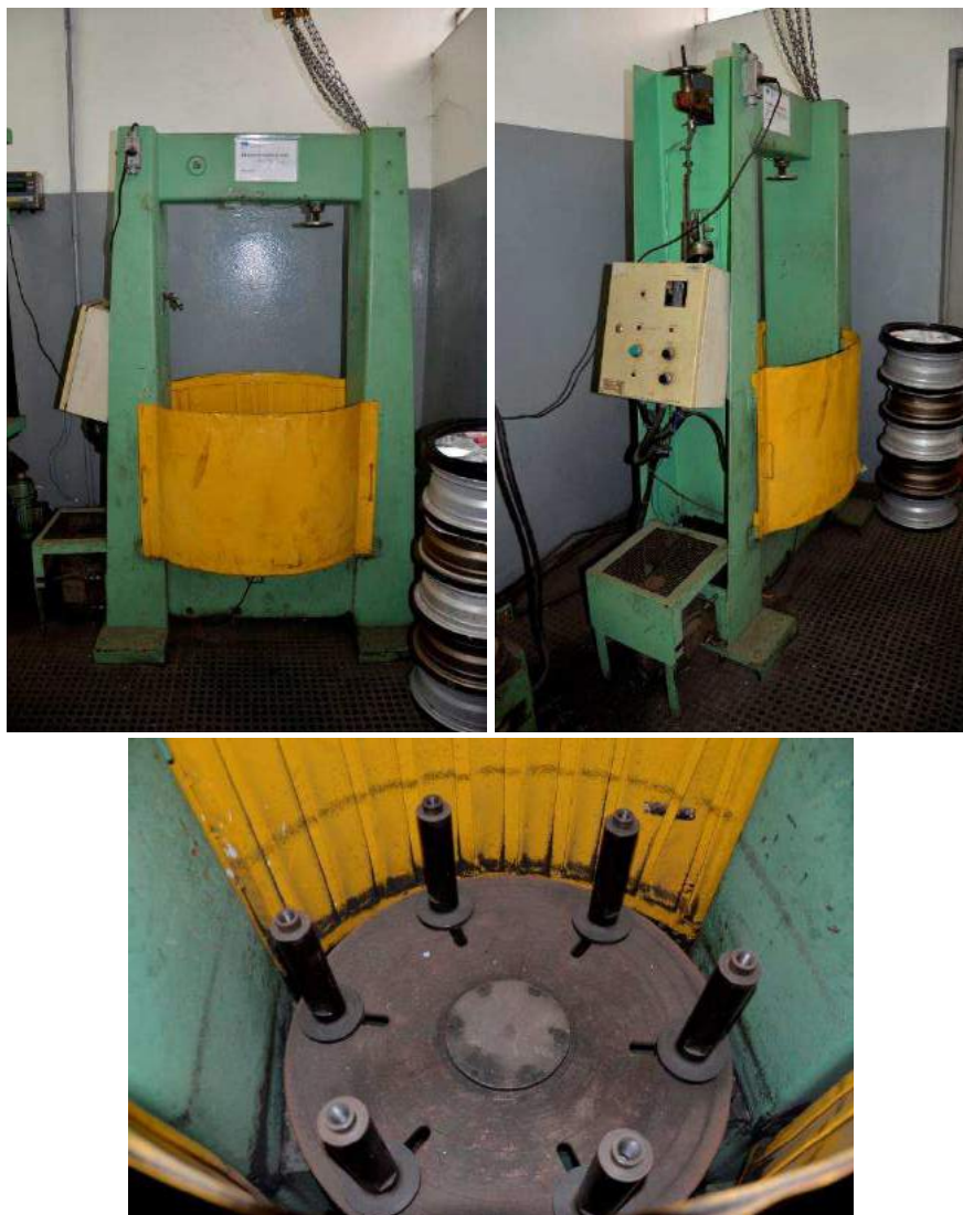
FIGURA 48 - MAQUINA DE ENSAIO DE FADIGA DO CUBO DAS RODAS DE LIGA LEVE
