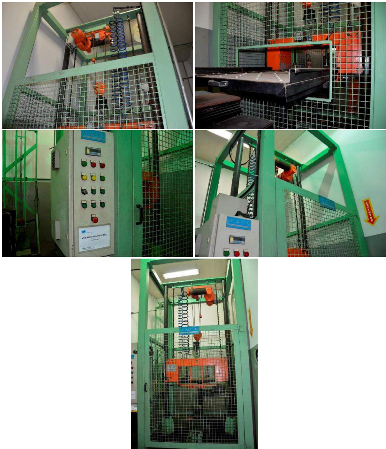
FIGURA 47 - MAQUINA DE TESTE DE IMPACTO - PROJECTUS
