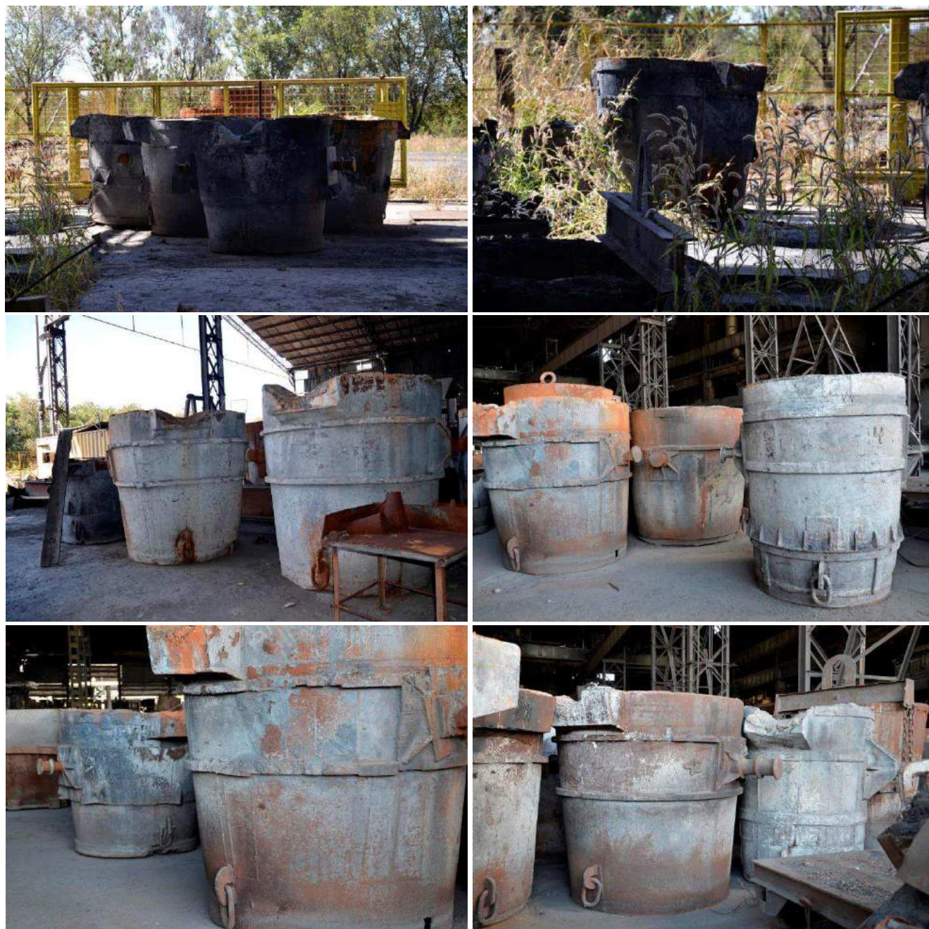
FIGURA 28 – PANEIS DE VAZAMENTO
