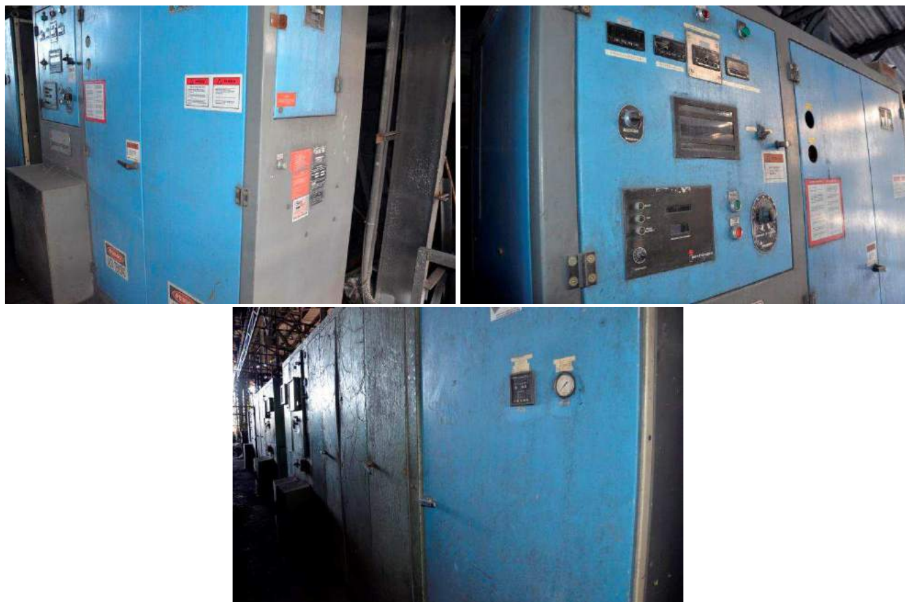
FIGURA 14 - FORNO INDUCTOTERM DE FUSÃO COM POSTO DE TRANS. T MODELO VIP PT5 - R, FORNO DE FUSÃO INDUCTOTHERM ST, CABINE INDUTOTERM VIP POWER - POT NORMAL
