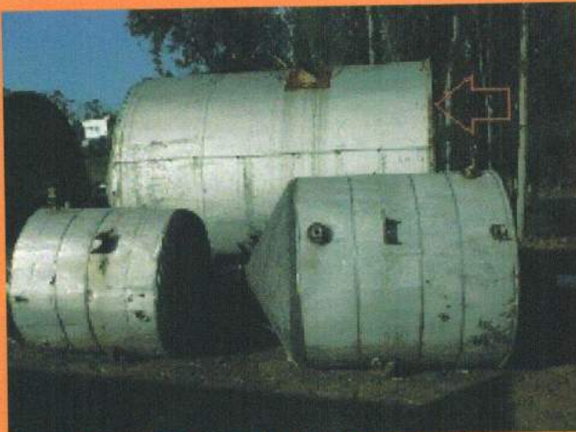
52. Tanque fundo cônico 26 m3 em inox
